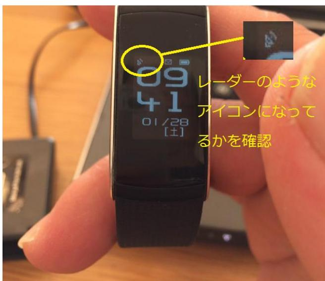
(3) そして、左図に示すような、時間表示のメイン画面の左上端に Bluetooth 接続状態を示すアイコンがレーダーのアイコンが出ているかどうかを確認します。
